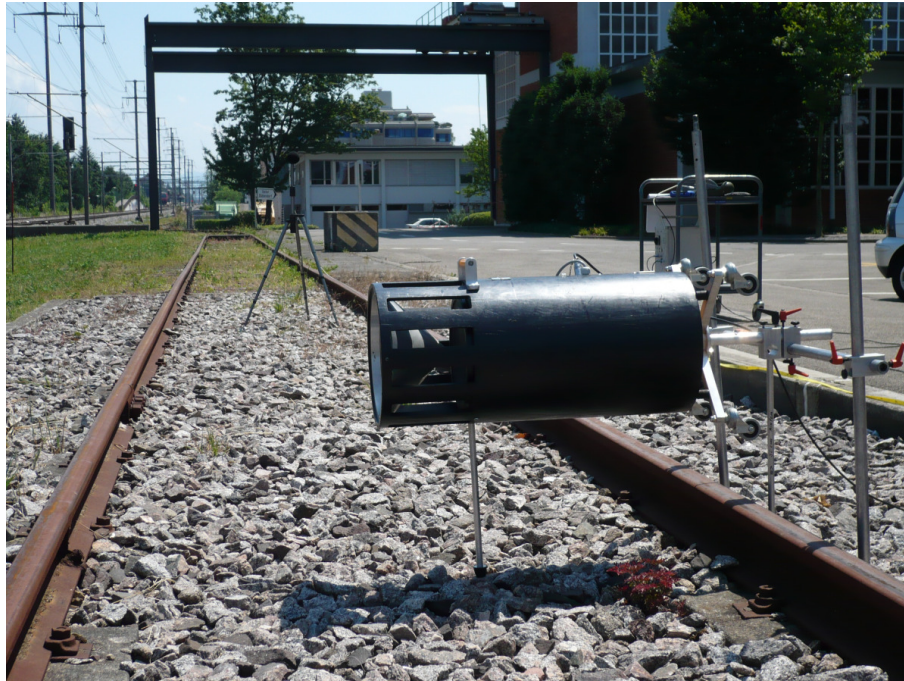
Abbildung 4.4: Schallausbreitungsexperiment auf einem Industriegleis mit dem anregenden Lautsprecher im Vordergrund und dem Mikrophon im Hintergrund.
